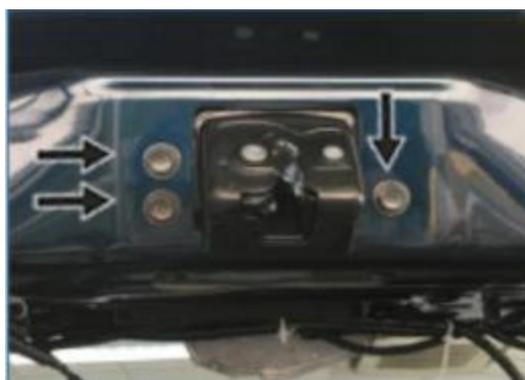
② 尾门吸合锁安装，如图所示位置用螺钉固定好吸合锁，锁紧扭矩不小于5Nm
