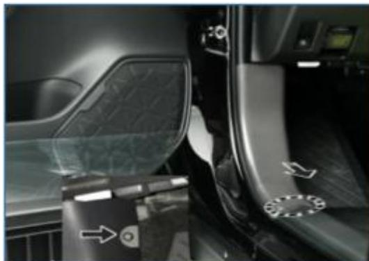
③ 拆中控按键饰板，卸掉螺钉后，将手置于图示位置沿拆卸方向拉动以分离卡爪和导销
