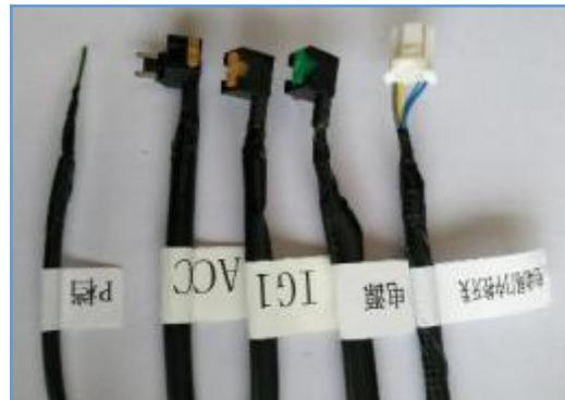
④ 将如图插件端子线束向尾门侧穿线。
