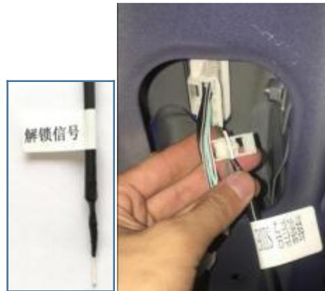
⑦ 如图所示找到电动尾门中控开关接插件与中控开关相连。
