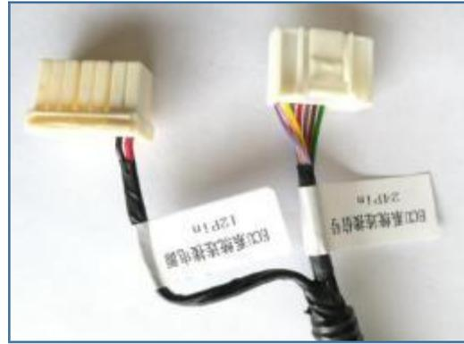
③ 将如图插件端子线束向车前方穿线。
