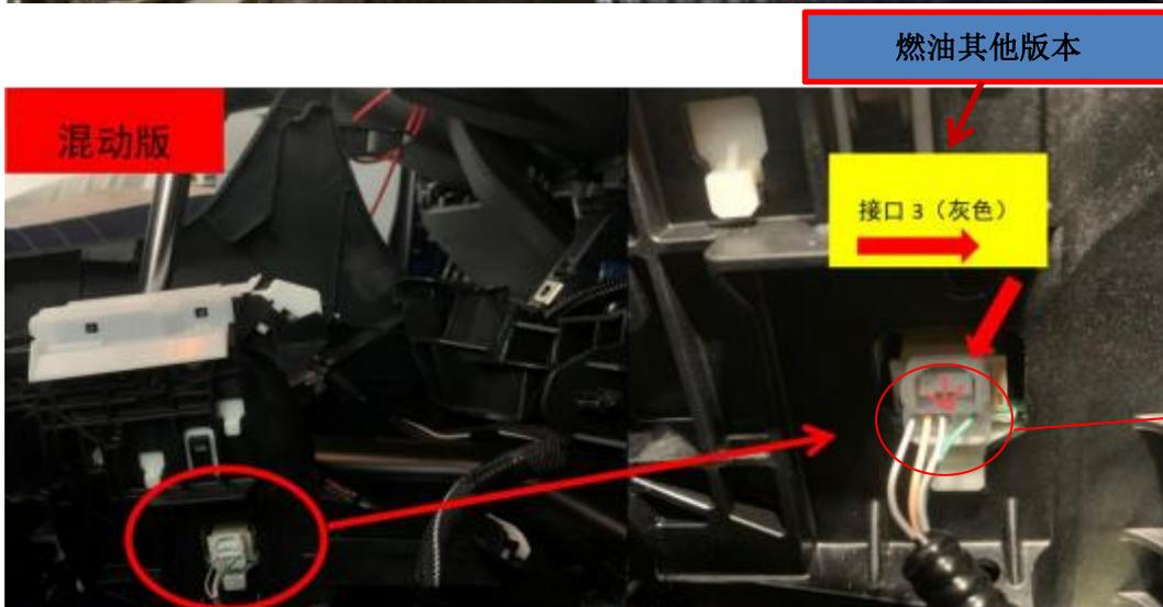
Ps:2021 年 11 月后生产的混动威兰达 P 挡线 (灰色) 变更至右一的端口，颜色不变
