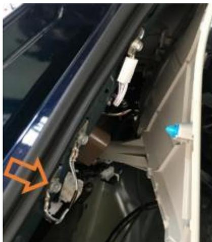
③ 连接地线。工具：10mm 套筒，紧固扭矩不小于5Nm。
