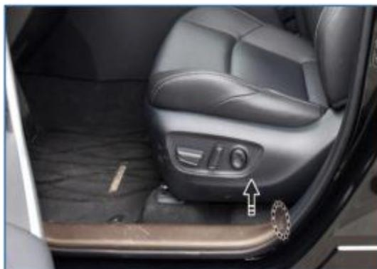
② 拆左前门踏板前方饰板，卸掉螺钉后，将手置于图示位置沿拆卸方向拉动以分离卡爪和导销。
