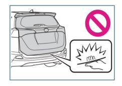
●使用电动尾门闭合器时要小心,因为电动尾门系统取消后尾门闭合器仍会工作。
